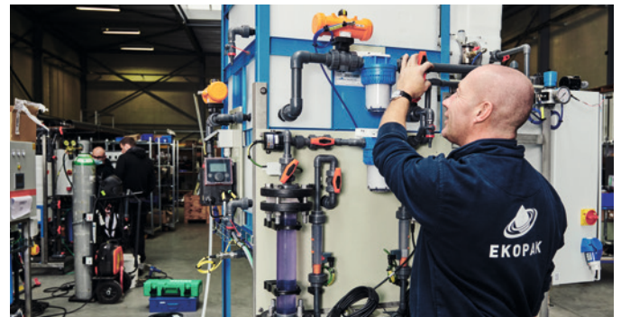
Ein Skid für die Wasseraufbereitung wird bei Ekopak in Belgien vorbereitet.
